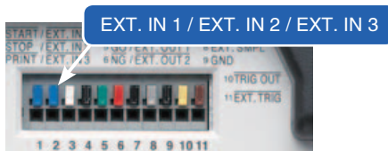
外部控制端口
