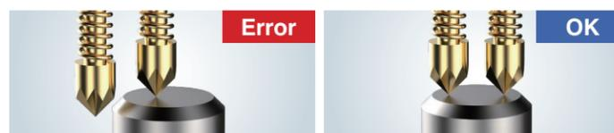
为了确保正确的测量，精准的探针下压必不可少。日置 HIOKI 的电池测试仪，搭载了监视探头接触状态的功能，检测结果信赖度高。
