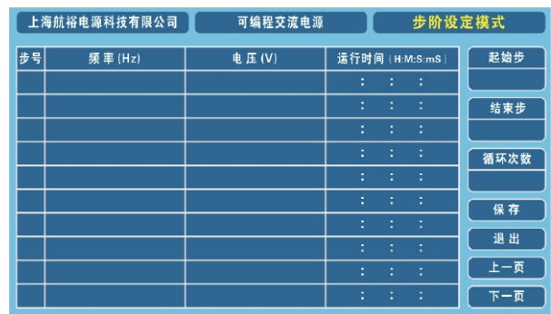
步阶设置页面可设置所需频率、电压、运行时间、初始步、结束步和循环次数
